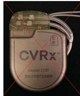
Inkorrekte Positionierung der Ableitung hinter dem IPG
