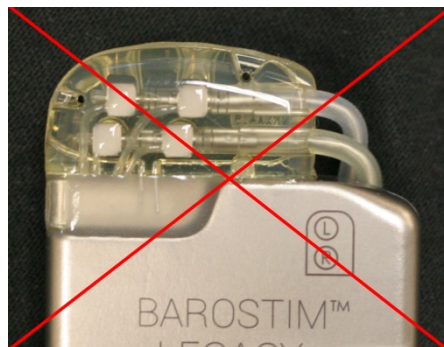
Incorrecte ernstige hoek in lead vanaf kop
