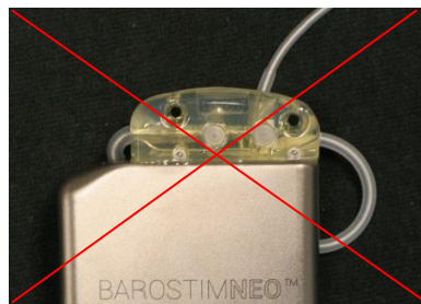
Onjuiste plaatsing van de lead achter de IPG
