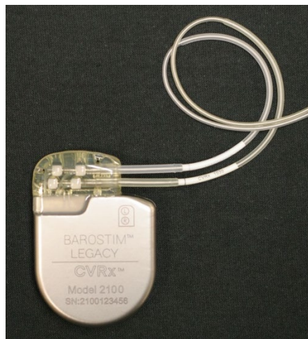
Abbildung 10: Korrekte Platzierung des überschüssigen Ableitungskörpers
