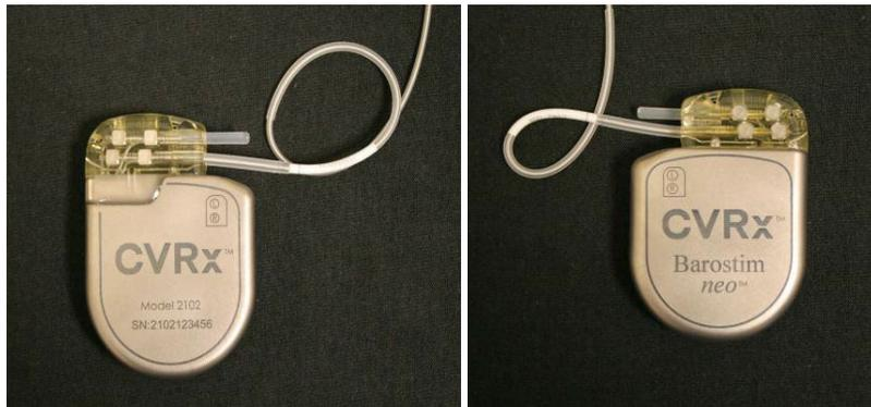
**Abb. 20: Korrekte Positionierung des überschüssigen Ableitungskörpers**
